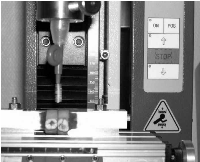
Abbildung 3 Universalprüfmaschine Zwicki-Zwick zur Messung der Einführwiderstände
