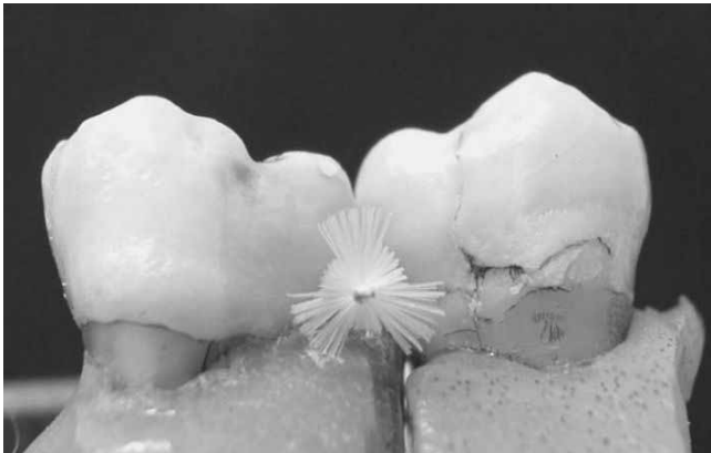
Abbildung 1 Interdentalbürste mit dreieckigem Querschnitt im simulierten Interdentalraum
